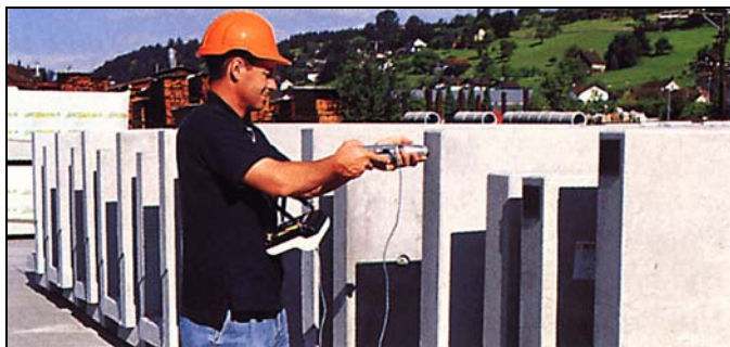
Проведение массовых испытаний сборных бетонных элементов с автоматическим занесением результатов в память прибора.
